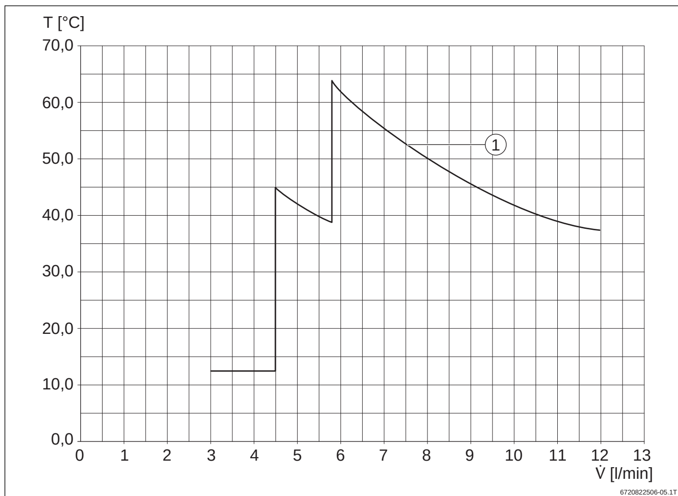
Bild 4 Kennlinie Durchlauferhitzer 21 kW
