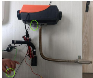
Wyjmij rurę olejową i załóż ją ponownie po normalnym ustawieniu
