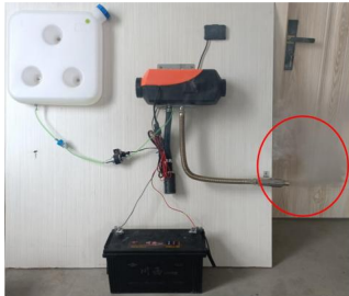
För mycket pumpolja producerar vit rök
