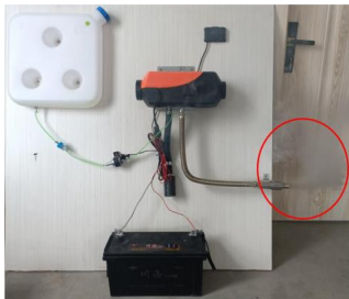
L'eccesso di olio nella pompa produce fumo bianco
