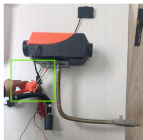
Dmchnij sprężonym powietrzem w stronę rury dolotowej, aby wspomóc spalanie
