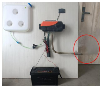
Nadmierna ilość oleju w pompie powoduje powstawanie białego dymu
