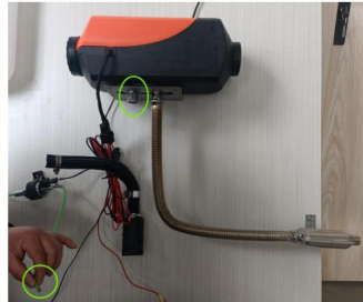
Verwijder de olieleiding en plaats deze terug nadat deze normaal is
